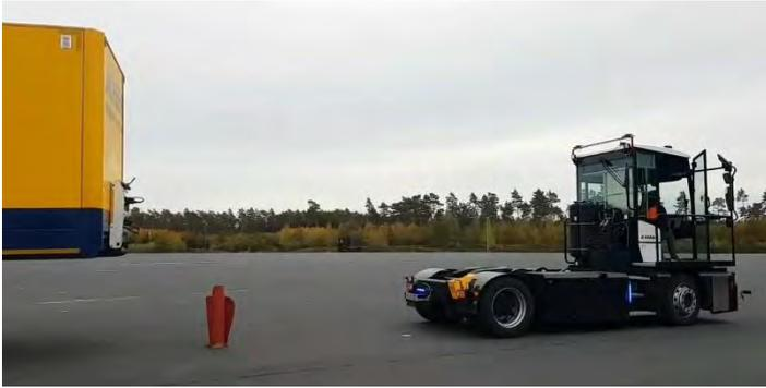
Abbildung 156: Test der Schutzfeldfunktion mit Hilfe einer Schaumstoffmatte beim Ankuppelungsmanöver
