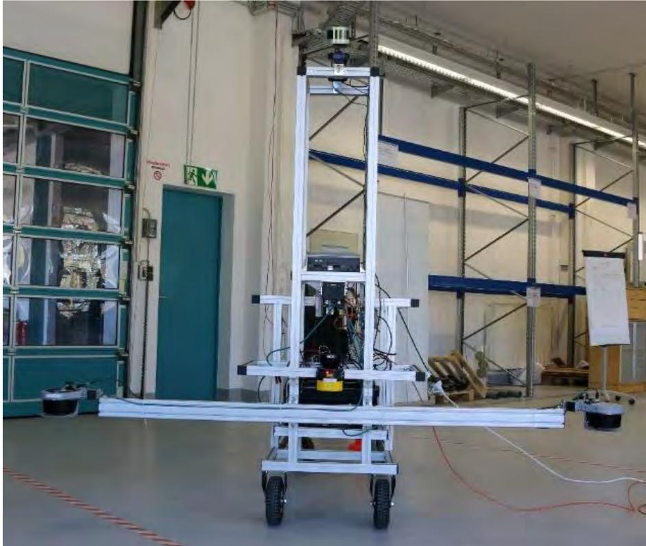
Abbildung 113: Messfahrzeug mit realitätsnaher Breite, verbauter Sensorik, Datenverarbeitungseinheit und Spannungsversorgung.
