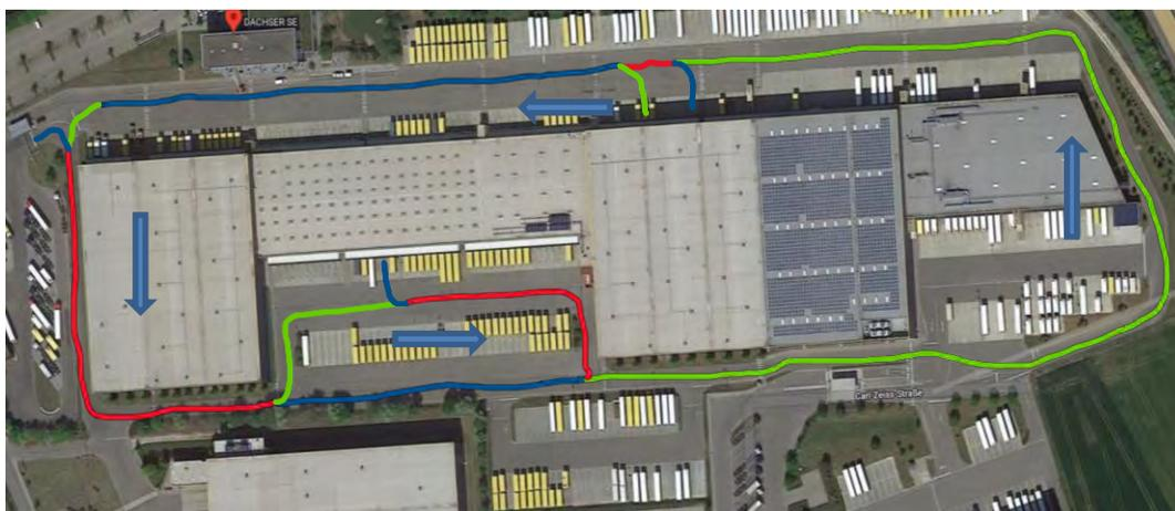
Abbildung 95: Skizze für eine einfache City-Map zur Suche nach dem kürzesten Pfad auf einem Netzwerk der gespeicherten Pfade. Die Suche erfolgt mit der Hilfe des TruckTrix-City Pfadplaners. Alle Pfade haben eine vorgegebene Richtung und können über eine Liste erlaubter Fahrzeuge verfügen.
