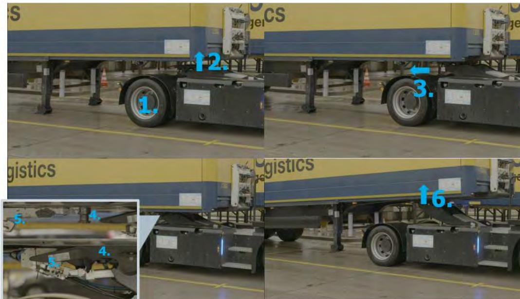
Abbildung 66: Ablauf des Kupplungsprozess am KAMAG PT
