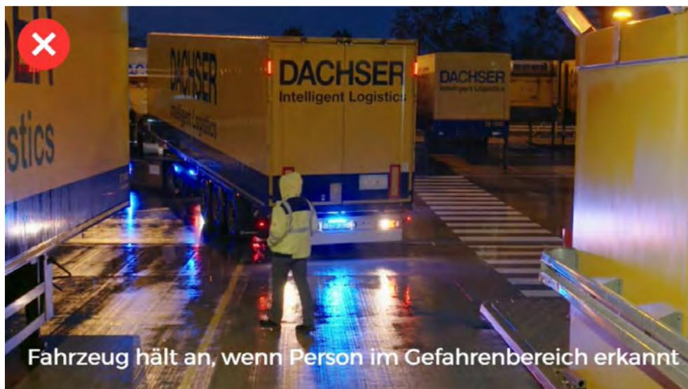
Abbildung 57: Bei der Detektion von Personen im Gefahrenbereich wird die Warnleuchte aktiviert und das Fahrzeug gestoppt (Ausschnitt aus SAFE20-Projektfilm).
