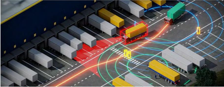
Abbildung 99: Dezentralisierter Einsatz von Infrastrukturknoten zur Erweiterung des Objekterfassungssystems (schematische Darstellung aus SAFE20-Erklärfilm, ISK mit grünen Wellen dargestellt).
