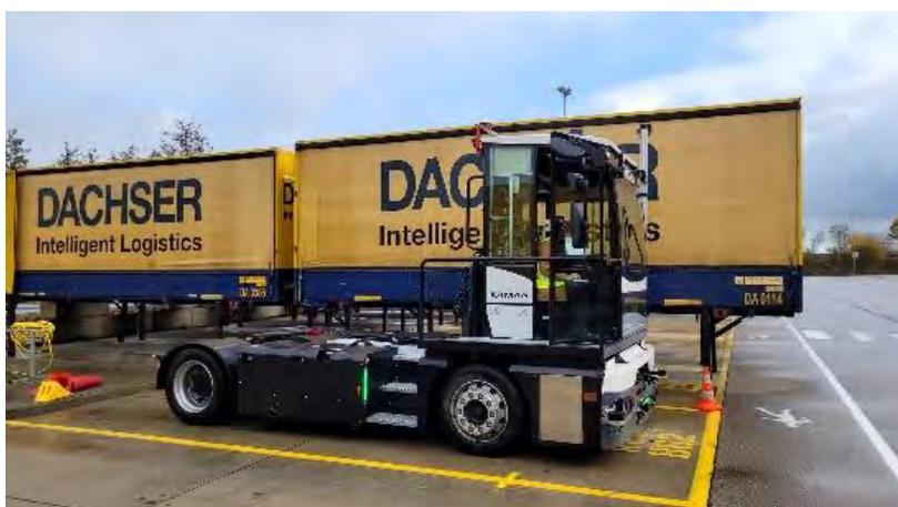
Abbildung 170: KAMAG PT auf dem DACHSER-Hof nach Anbau der Sensorik auf seinem zugewiesenen Stellplatz
