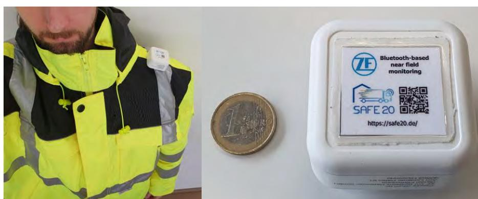
Abbildung 53: Zur Lokalisierung notwendige Bluetooth-Tags können magnetisch an der Kleidung befestigt werden
