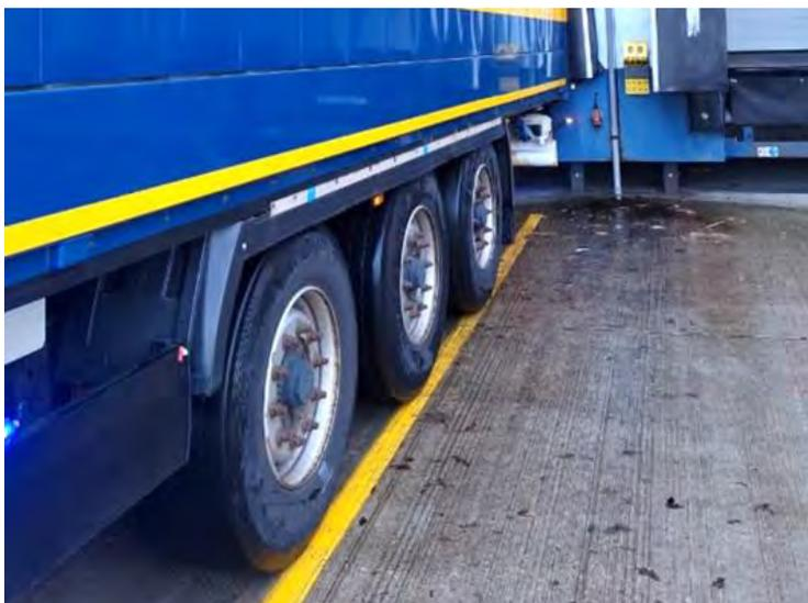
Abbildung 181: Erfolgreicher Endzustand beim Andocken eines Trailers an eine Rampe
