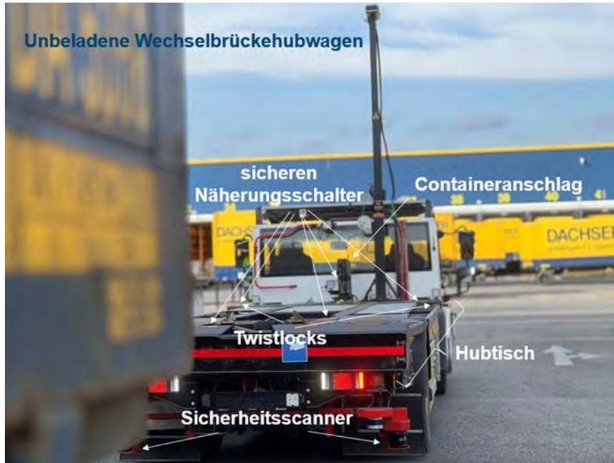
Abbildung 76: Ausrüstung des Wechselbrückenhubwagens für ein sicheres Wechselbrücken-Handling
