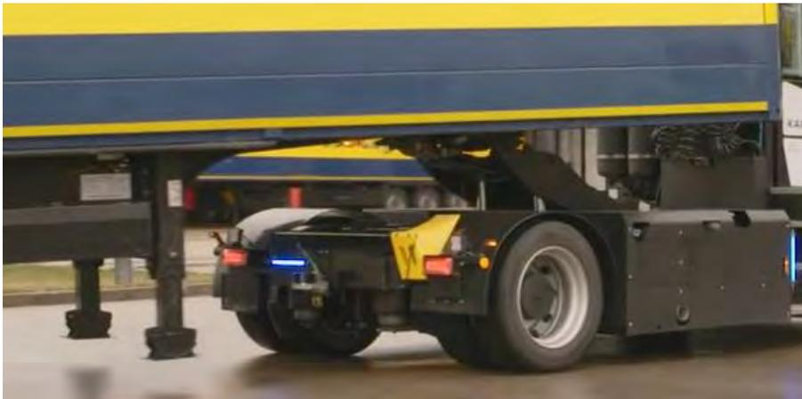
Abbildung 68: Stützfüße in ausgefahrener Position mit noch ausreichender Bodenfreiheit durch über den Liftarm angehobenen Auflieger
