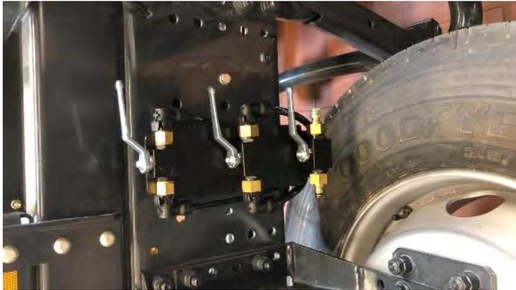
Abbildung 34: Kugelhähne zur manuellen Umschaltung zwischen der prototypischen ausfallsicheren Feststellbremse EPH und der klassischen Feststellbremse mit zusätzlichen elektrischen Ventilen im Versuchsfahrzeug
