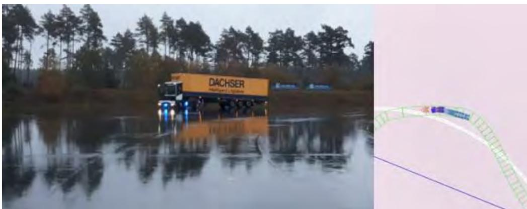
Abbildung 72: Autonome Fahrt auf der ZF Testbahn in Jevern mit Auflieger, rechts Onlinevisualisierung
