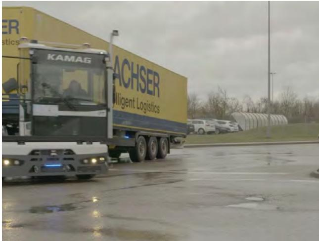
Abbildung 73: Autonome Fahrt um eine Kurve mit Sicherheitsfahrer in der Kabine auf dem DACHSER Betriebsgelände in Langenau
