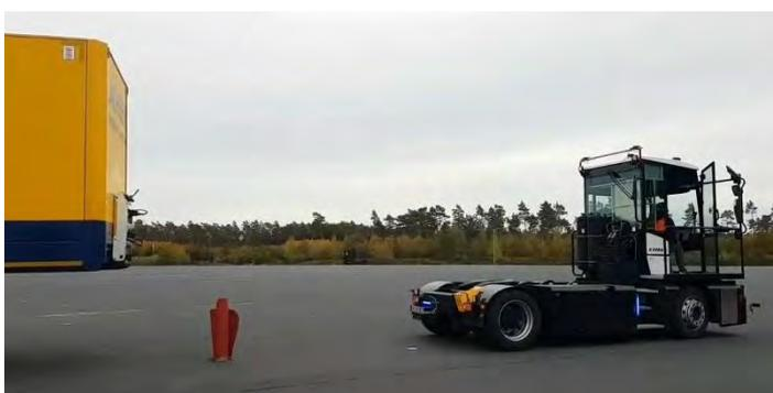
Abbildung 141: Test der Schutzfeldfunktion mit Hilfe einer Schaumstoffmatte beim Ankuppelungsmanöver
